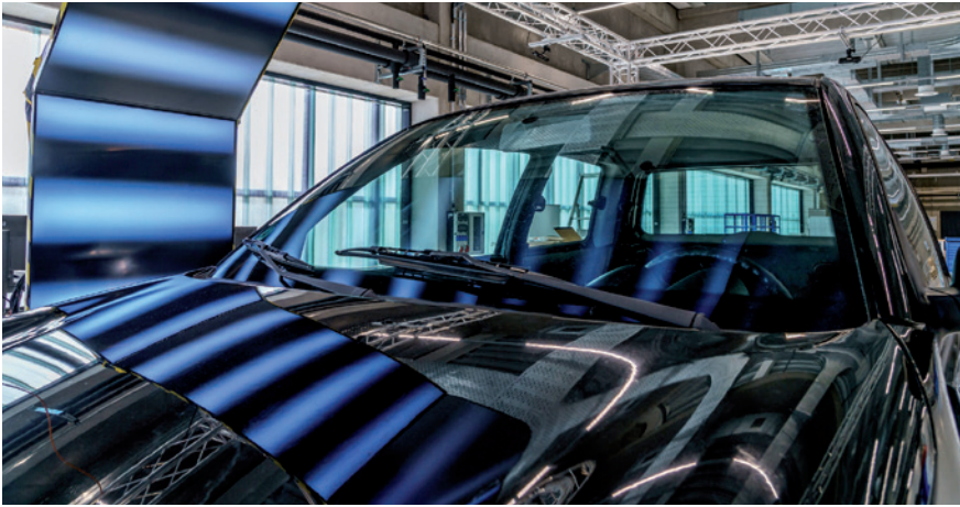
Im Projekt AutoInspect werden beliebige Prüfbjekte automatisiert inspiziert, die Ergebnisse der Sensorik fusioniert und auf einen gemeinsamen Digitalen Zwilling referenziert.
