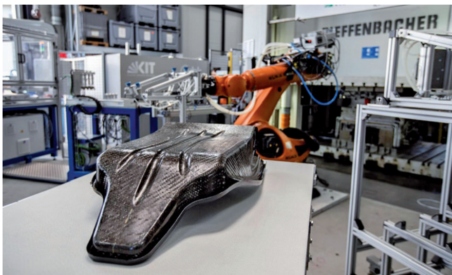
Vollautomatisierte Produktionszelle zur Herstellung hybrider Thermoplast-Strukturbauteile (MoPaHyb Projekt). Das Transferzentrum »Hybrider Leichtbau« am Fraunhofer ICT steht mehrere Jahre für Schulungen zur Verfügung.
